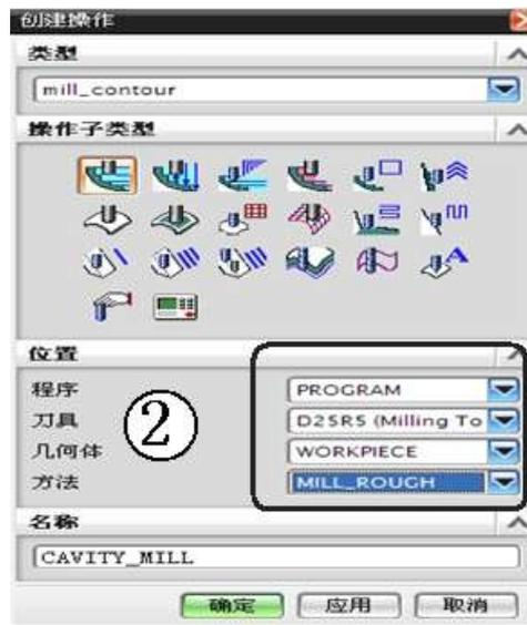
▲，经过分析：发现最小圆角半径为 3mm，最小区域间的距离为 8.15mm，所以要想完全加工干净工件，所需最小刀具为 D6R3 的刀具。这只是小区域的情况，另外的大面积区域则比较大，所以使用较大的刀具进行开粗和半精加工以及精加工，最后使用较小的刀具进行清根。因此创建 D25R5 用于开粗加工、D12R1 用于粗清角和半精加工、B12 的球刀精加工、D6 的平刀清理 12 的刀具加工不到的区域、最后使用 B6 球刀进行最后的清根。自己创建好这些刀具。
