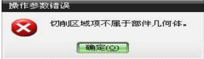
**▲ 容错加工是指——系统自动寻找不过切的可加工的区域的方法，如果你不启用它，那么系统怎么会找到你所指定的切削区域呢？所以当你不启用此选项时，系统直接就在几何体定义区不再显示**
