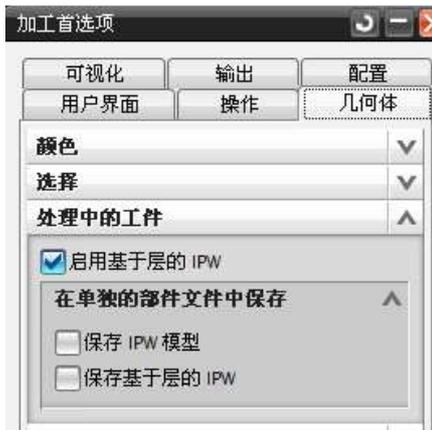
▲，同使用 IPW 一样，操作定义在同一几何体下、按顺序成功产生。严格地遵从父级组参数传承关系。
