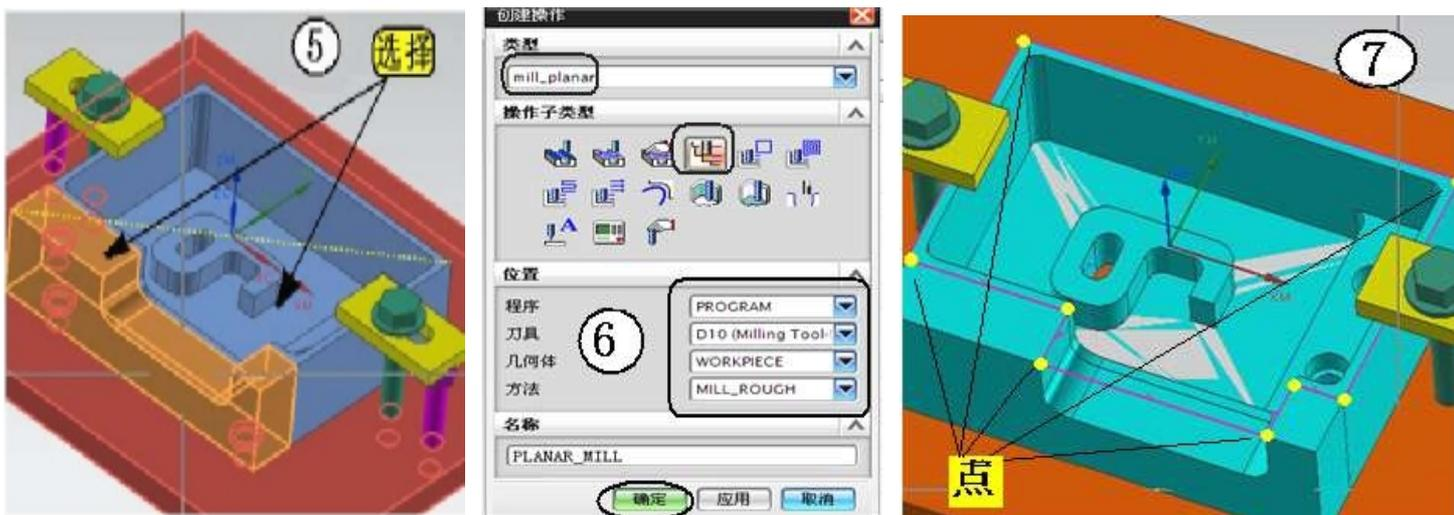
第三步：先创建一把名为 D10 刀具直径=10 的平底刀（步骤省略），然后点击 创建平面铣操作，按图中设置相应的父级组（上图⑥所示）→弹出平面铣对话框：①先定义零件边界：点击图标 →选择 **点模式** 生成边界方式，在图形区选择零件上表面轮廓线的角点（材料侧选择外侧，因为要加工轮廓线内部）（上图⑦所示），此选择是明确加工的大范围，然后再进一步的细化即分别定义腔体内的 2 个凸台边界：使用默认的 **‘面’选择模式**，直接点选零件内部的带有圆孔的凸台（注意先勾选  穿孔），材料侧为内部）。不要按确定退出，继续切换为 **曲线/边模式**，选择腔内 6 字型上表面轮廓线，注意材料侧的选择—外轮廓线为内侧、内轮廓线为外侧如（下图⑦—1 所示）。确定 3 次后退回边界对话框，至此零件边界定义完毕。
