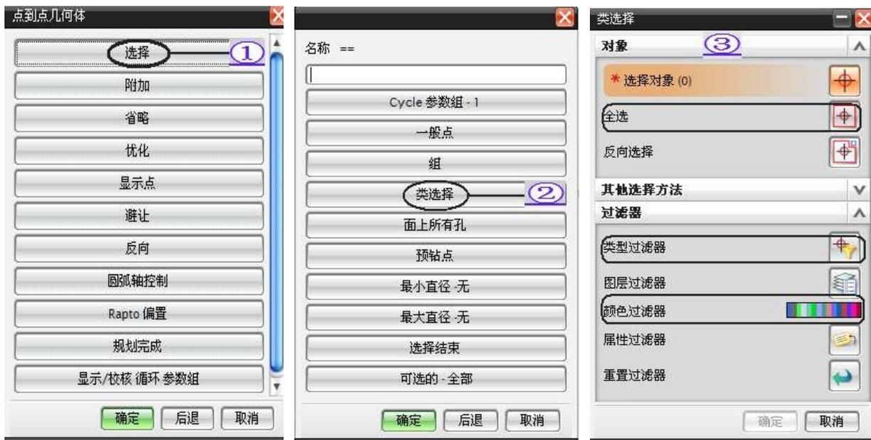
▲，选择蓝颜色的点：点击 Cycle 参数组 - 1 弹出组对话框（下图④所示）、选择 参数组 2 即指定蓝颜色的点为第二组→再按照前面的步骤继续选择蓝颜色的点。点击 确定 完成回到点到点几何体对话框。
