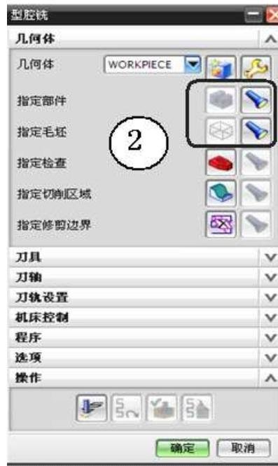
第三步：在型腔铣对话框中，我们可以看到：指定部件、指定毛坯，已经继承了 WORKPIECE 中的几何信息，手电筒已经变亮了。即是说已经定义了零件几何体和毛坯几何体。这时直接点击图标
