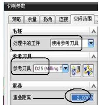
第 3 步: 点击生成刀轨图标
