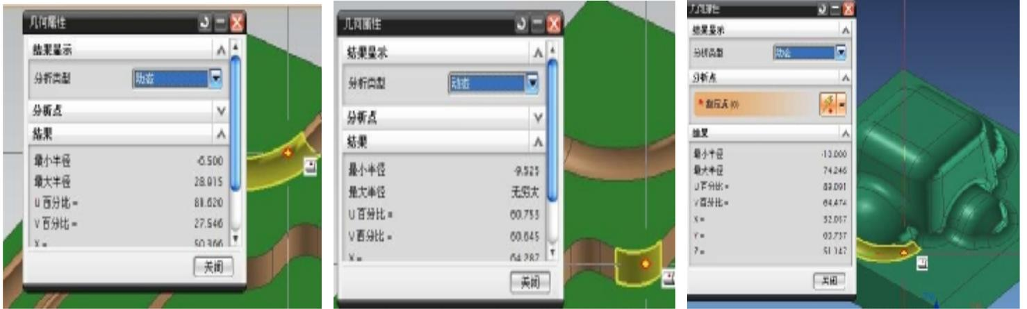
**C. 分析距离和长度：**使用测量距离命令可以计算两对象之间的距离、曲线长度或圆弧、圆周边或圆柱面的半径。点击“分析”→“测量距离”，弹出测量距离对话框，直接点选 2 个点或点选 2 个面或点选 2 条直线，或者点选：点与面，点与直线，直线与面等都能直接测量出两者之间的最短距离。如下图所示：这里需注意的是：所测量的值与坐标系有关。
