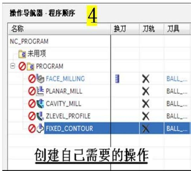
**步骤 4:** 设定好每一个操作一般情况下使用的基本参数，以后就不必重复的指定常用的参数了——即：使之成为默认的参数：双击一个操作进入编辑对话框：修改相应的参数——例如平面铣修改的示意图如（下图 5、图 5-1）所示。（这里仅列出几个，其它还包括：进退刀参数、主轴转速、进给率等相关的参数，自己都可以进行设定）。其它的操作类型都可以依次类推，设定适合自己需要的常规基本参数设置。修改完成后点击保存按钮 保存文件信息，关闭这个修改后的文件。
