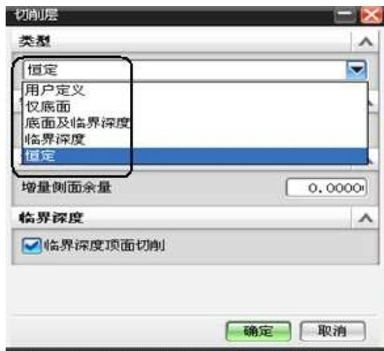
①，恒定：指定一个固定的深度值来进行多层切削。在这种方式下有下列参数：
