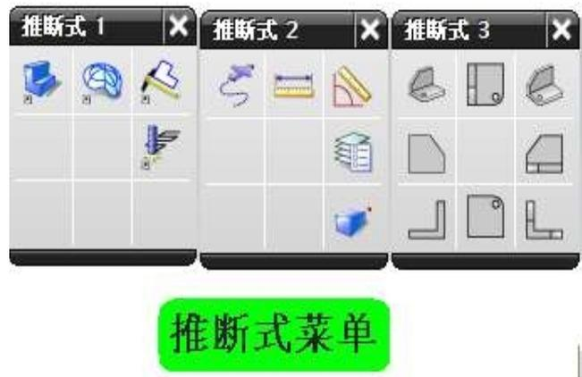
而至于 3 个推断式是 UG 的增强功能，或者简称是隐形图标。有了它们就可以不用上面的那些工具条了，即是无图标操作化。极大的节省屏幕上的空间，且极大的显著地提高操作速度，是超级好用的工具，但不适合初学者。
