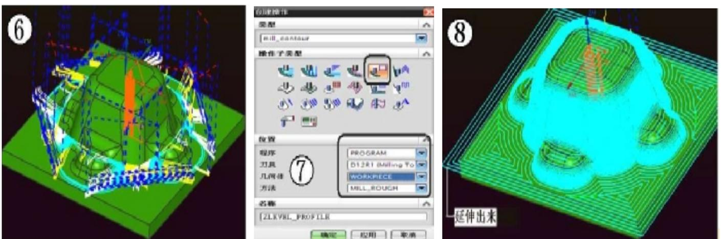
▲,经过 D12R1 的刀具清理残料后,再接着使用 D12R1 的刀具半精加工是没有问题的——不会在角落位置出现切削量过大的问题:直接创建等高轮廓铣操作 ZLEVEL\_PROFILE (如上图⑦所示)并进入对话框——→同样指定切削的区域(同上图③)——→其它参数设置如下:每刀公共深度为 0.5、
